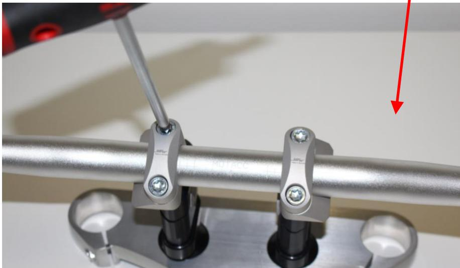
*Schritt 7: Die Schrauben der Befestigungsbolzen herausdrehen. Dabei darauf achten das sich nichts verdreht. Jetzt den Lenker mit dem Oberteil der V-Raiser nach oben wegziehen.*
