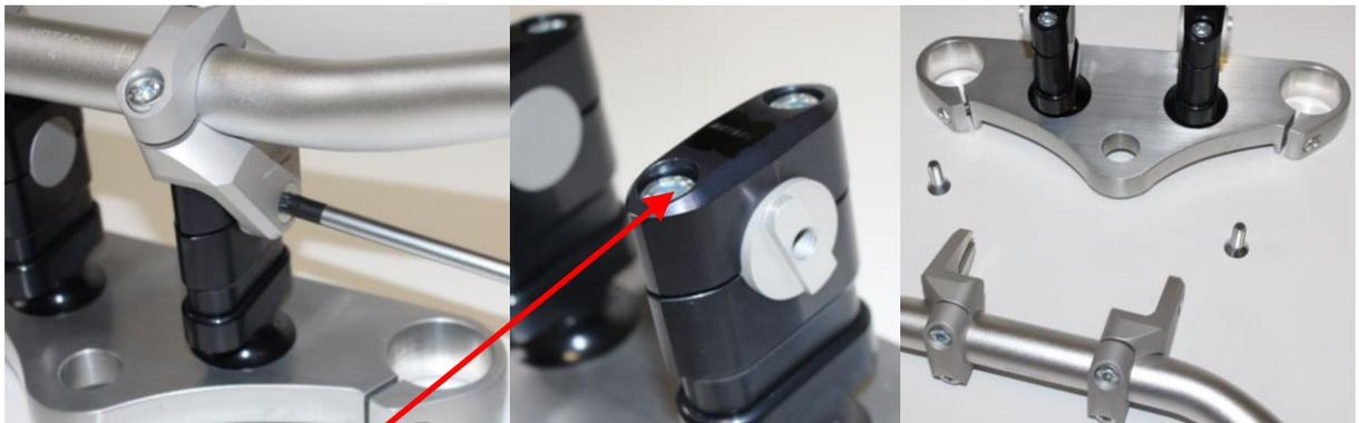
*Schritt 8: die 4 Klemmschrauben nach Herstellerangabe anziehen ( Richtwert für M8 = 25 Nm )*
